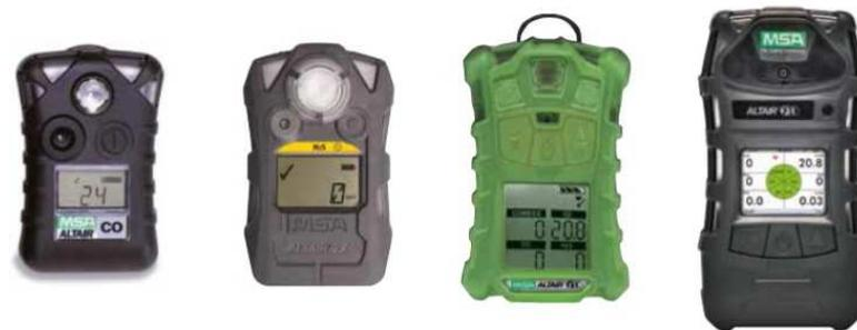
I rilevatori gas portatili possono essere esplosimetri, monogas o multigas
